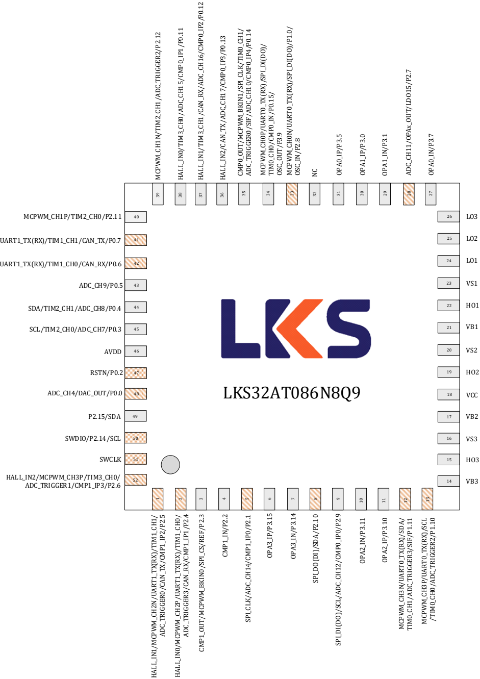
图 3-1 LKS32AT086N8Q9(B)管脚分布图
