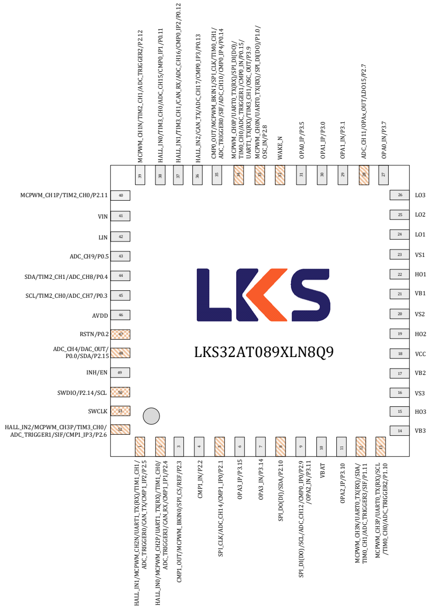
图 3-1 LKS32AT089XLN8Q9 管脚分布图
