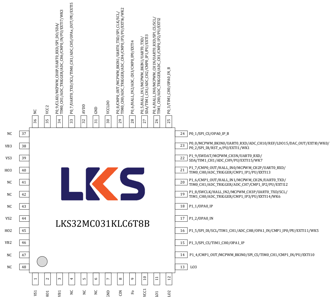
图 3-1 LKS32MC031KLC6T8B 管脚分布图
