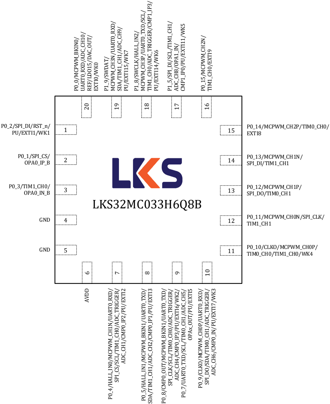
图 3-5 LKS32MC033H6Q8B 管脚分布图
