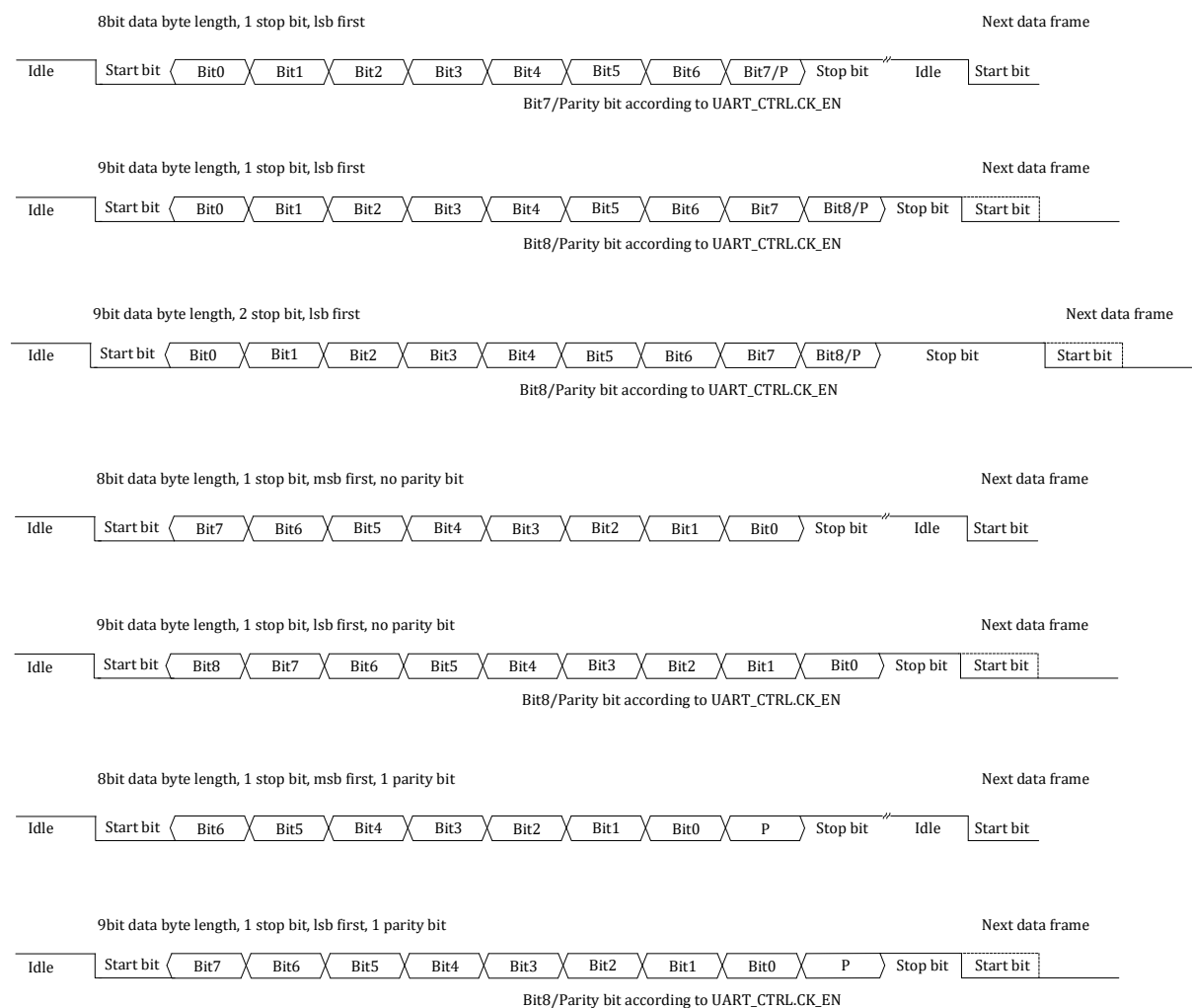
Fig. 16-2 UART Frame Format
