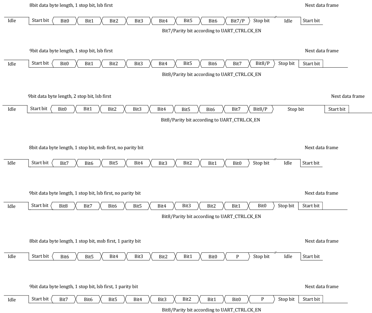
Fig. 16-2 UART Frame Format
