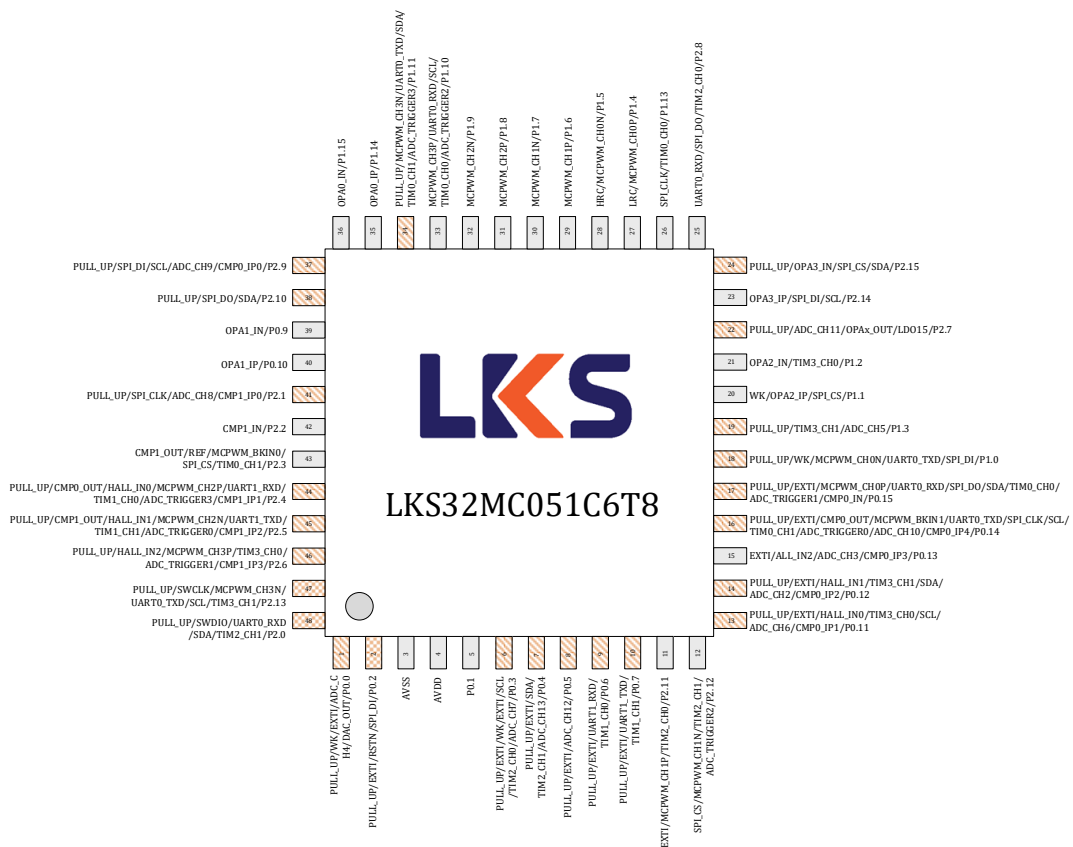
图 3-1 LKS32MC051C6T8 管脚分布图
