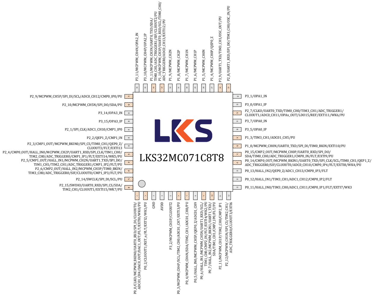
图 3-2 LKS32MC071C8T8 管脚分布图
