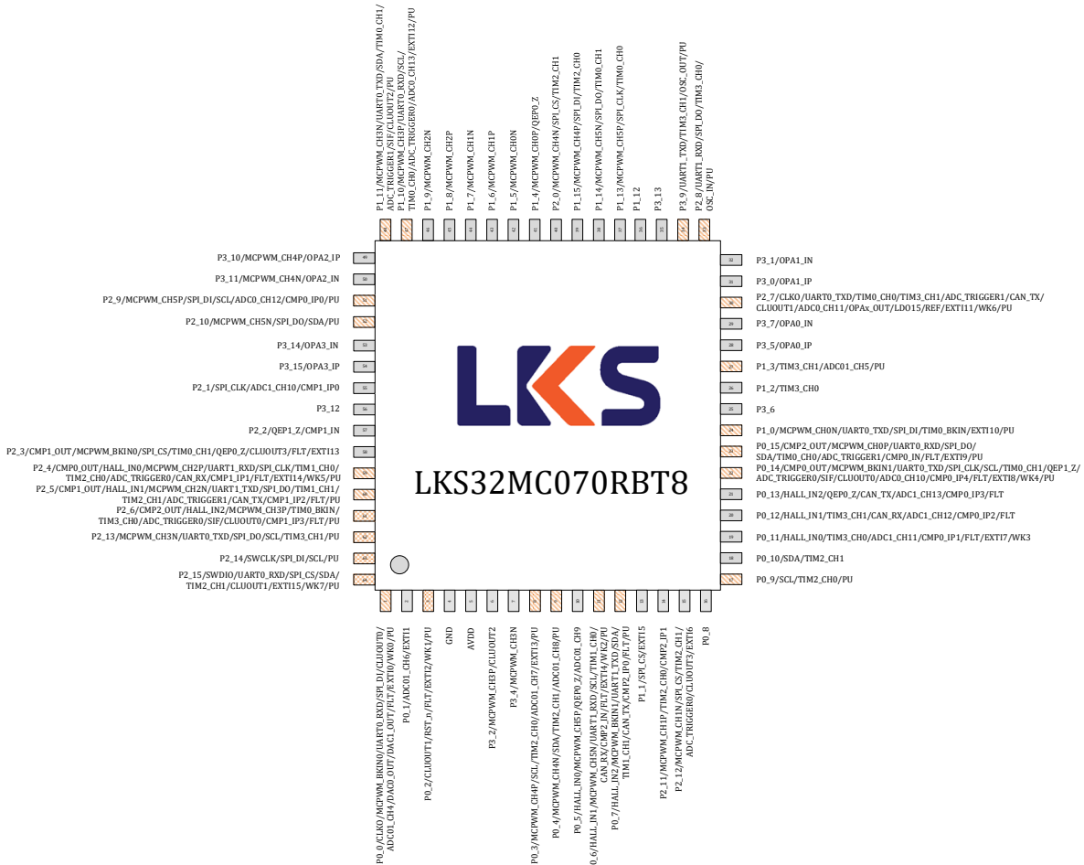
图 3-1 LKS32MC070RBT8 管脚分布图
