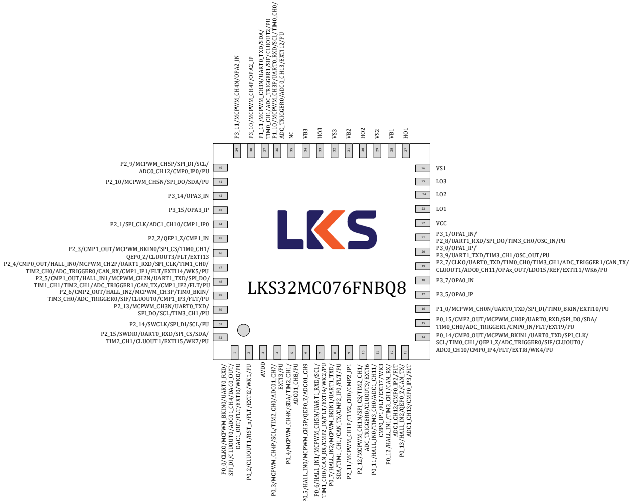
图 3-11 LKS32MC076FNBQ8 管脚分布图
