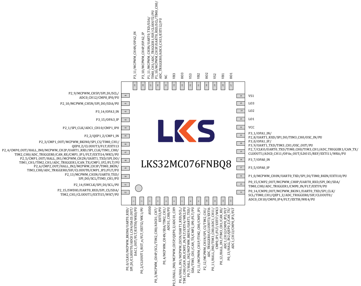
图 3-11 LKS32MC076FNBQ8 管脚分布图
