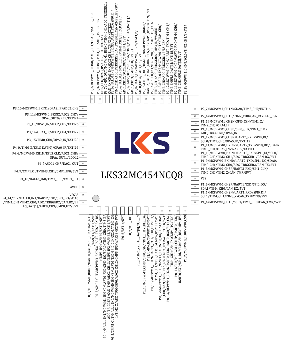
图 3-4 LKS32MC454NCQ8 管脚分布图
